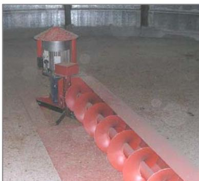
L'estrattore a coclea rotante BSP è utilizzato in silos di diametro fino a 18 metri, consiste in una coclea rotante aperta lungo un lato e con una protezione sul lato opposto. L'estrattore ruotando sul diametro del silos permette, insieme all'utilizzo di serrande intermedie, lo scarico del cono residuo. La capacità d'estrazione standard va fino a 60 m<sup>3</sup>/ora.
