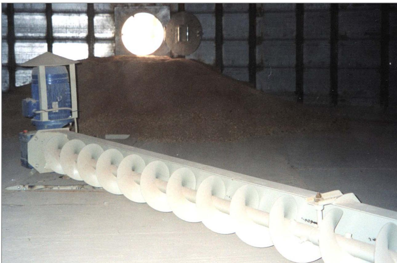
Tutti gli estrattori a coclea rotante sono dimensionati dall'ufficio tecnico di B.S.P. Engineering in funzione delle caratteristiche fisiche del prodotto, delle dimensioni dei silos e delle portate richieste.
