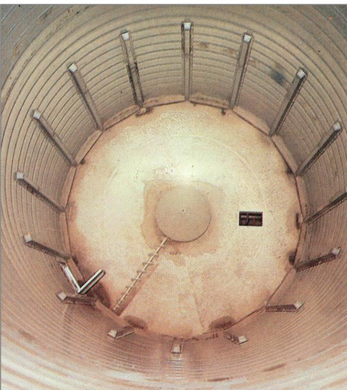
**Estrattori planetari Hydrobox utilizzati in silos di diametro da 2 fino a 9 metri.**
