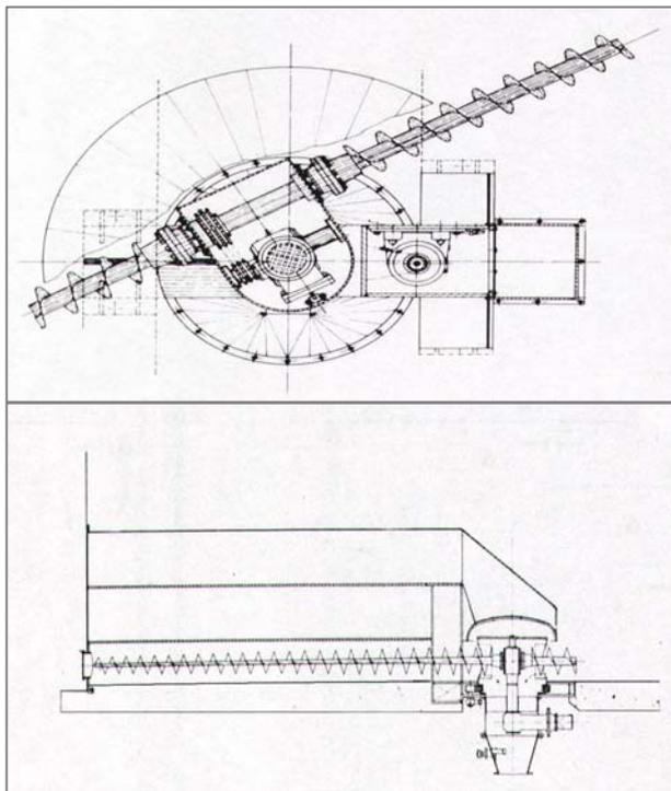
**Estrattori planetari Double Axis utilizzati in sili di diametro da 13 fino a 25 metri.**
